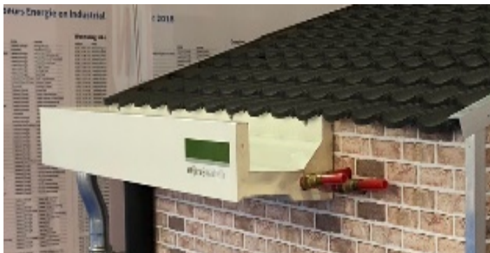
Bij de mock-up zijn de eerste testen gedaan met de productie van een kunststof gootprofiel.
